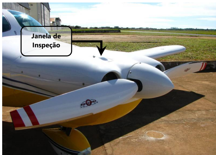
Figura 79.10.2 – Verificação do nível de óleo.
