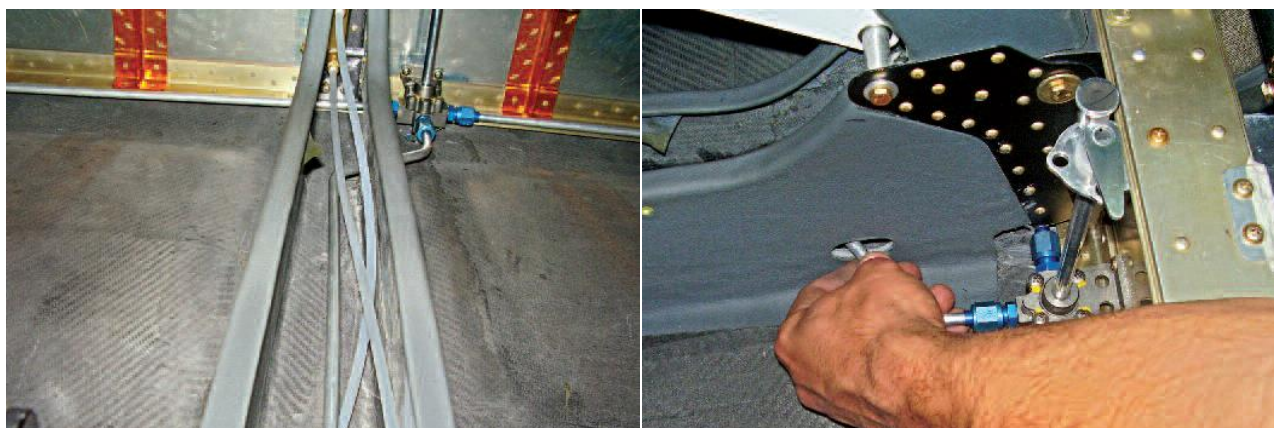
Figura 28.20.15 – Instalação do Tubo da Bomba de Combustível AA-28-20-400-44
