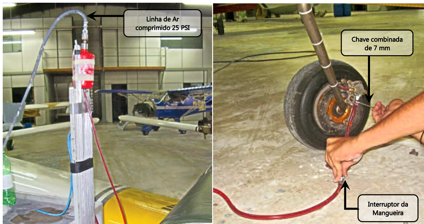
Figura 32.40.85 – Sangria do sistema de freio
