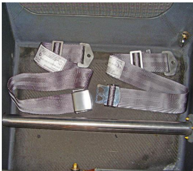
Figura 25.10.33 – Instalação do cinto de segurança abdominal
