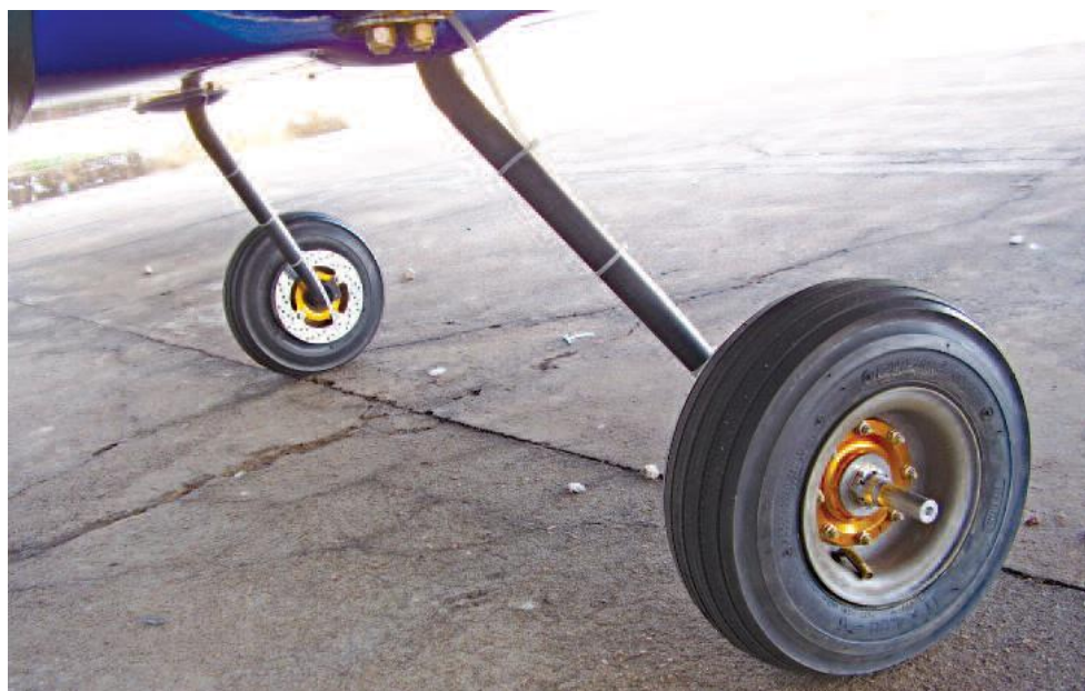
Figura 32.40.31 - Lubrificação na capa do rolamento, instalada no cubo da roda.
