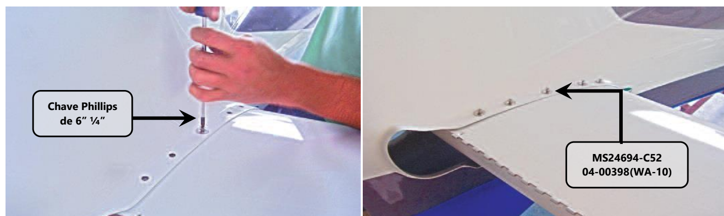
Figura 55.10.4 – Instalação dos parafusos do estabilizador (visão superior).
