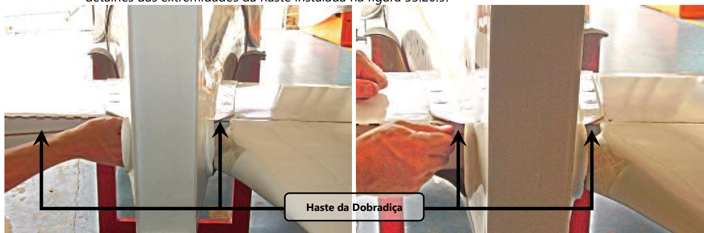
Figura 55.20.8 – Instalação da haste da dobradiça (vista de trás do Quasar).
