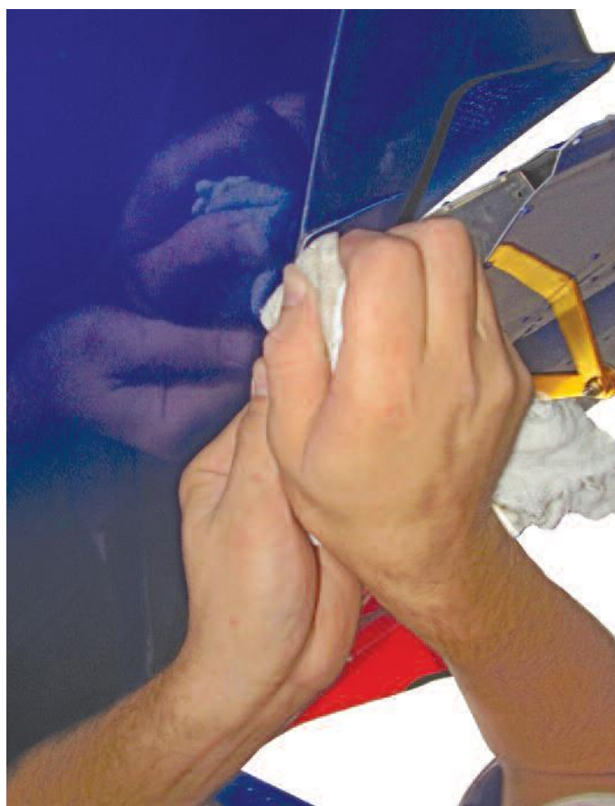
Figura 53.50.9 – Fixação da junção do intradorso da saia.
