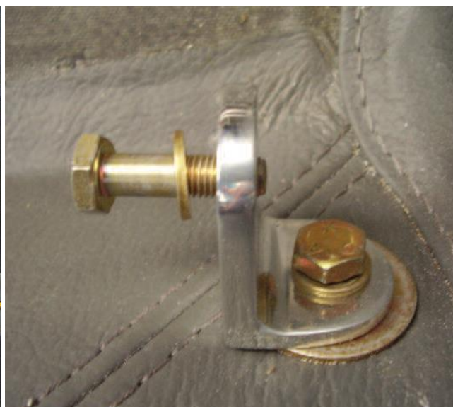
Figura 25.10.33 – Instalação do cinto de segurança abdominal
