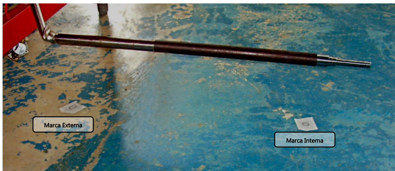
Figura 32.10.15 – Marcas do pendulo nas fitas adesivas no solo.
