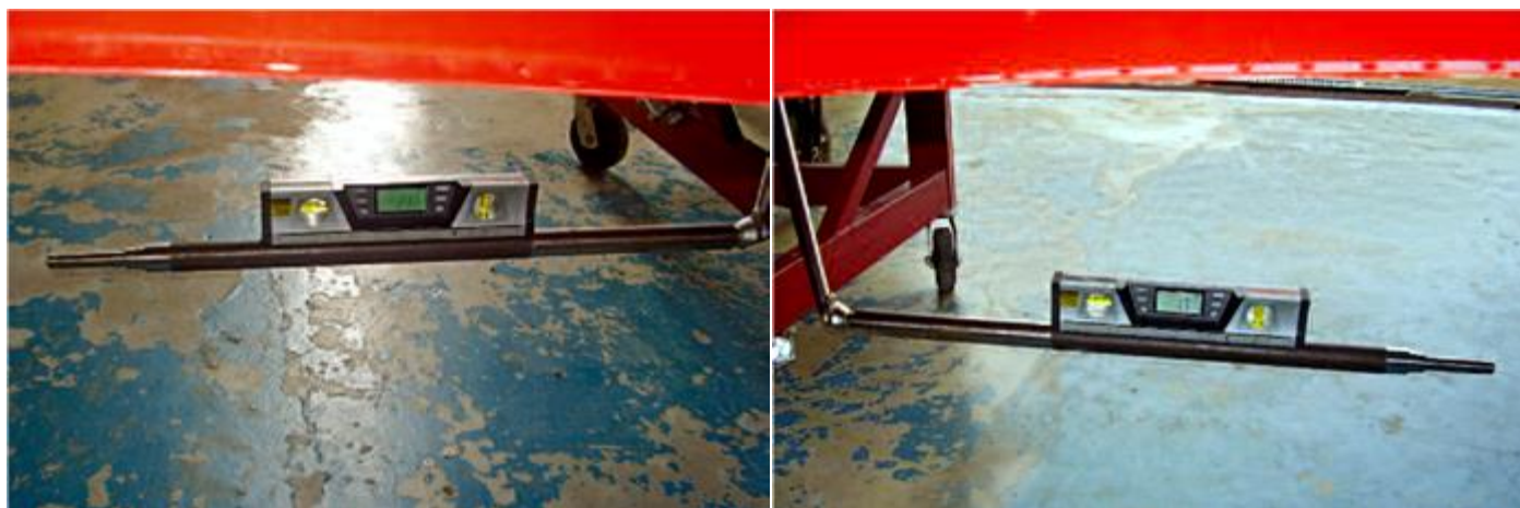
Figura 32.10.12 – Eixo esquerdo e direito - Cambagem.
