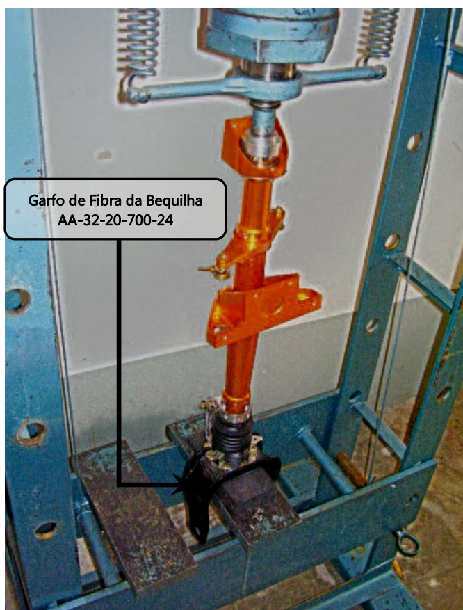
Figura 32.20.8 – Instalação da bequilha na prensa
