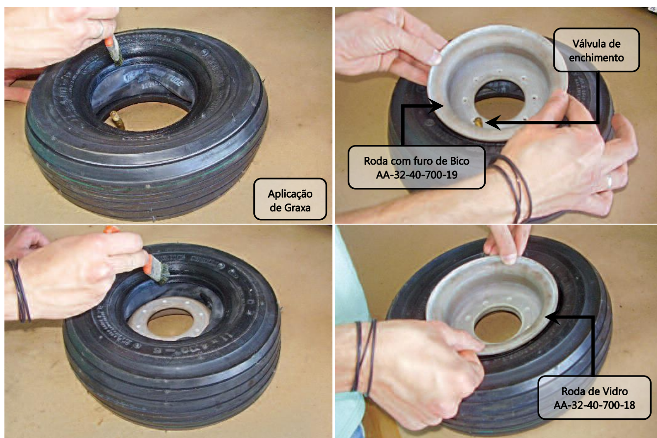
Figura 32.40.10 e 11 – Aplicações de graxa e encaixe da meia-roda em ambos os lados do pneu.
