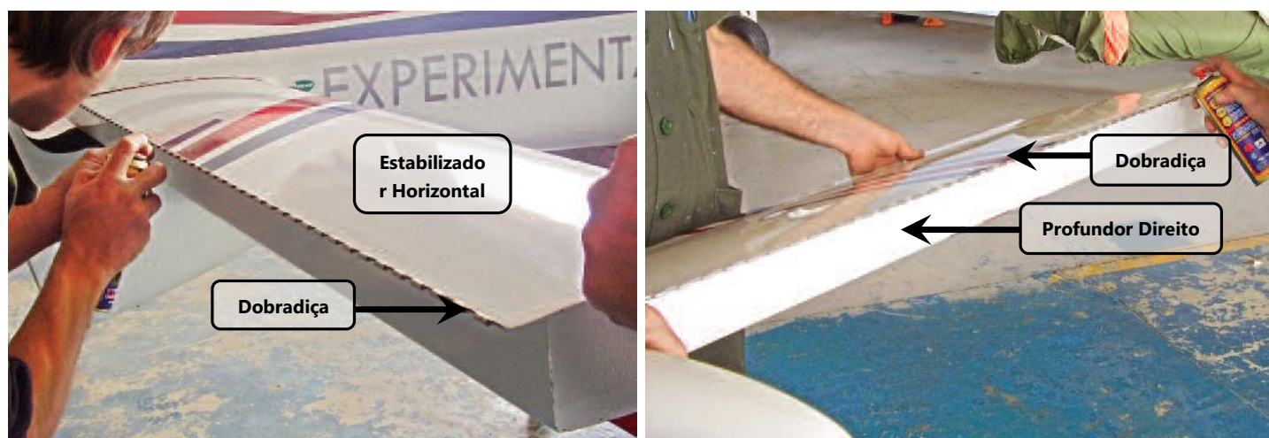
Figura 55.20.6 – Lubrificação das dobradiças do estabilizador e do profundor.
