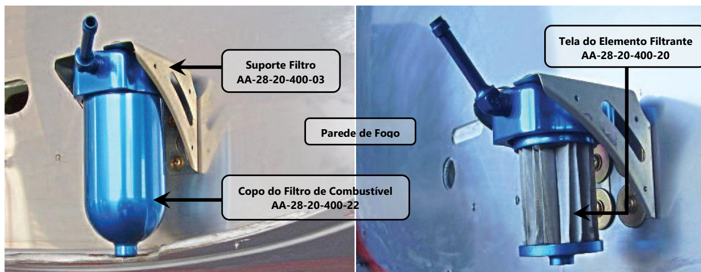
Figura 28.20.26 – Copo e tela do Filtro-decantador – AA-28-20-400-22
