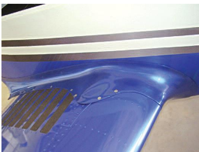
Figura 53.50.10 – Disposição final da saia no extradorso da asa.
