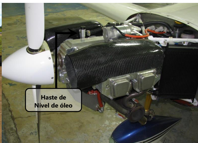
Figura 79.10.2 – Verificação do nível de óleo.
