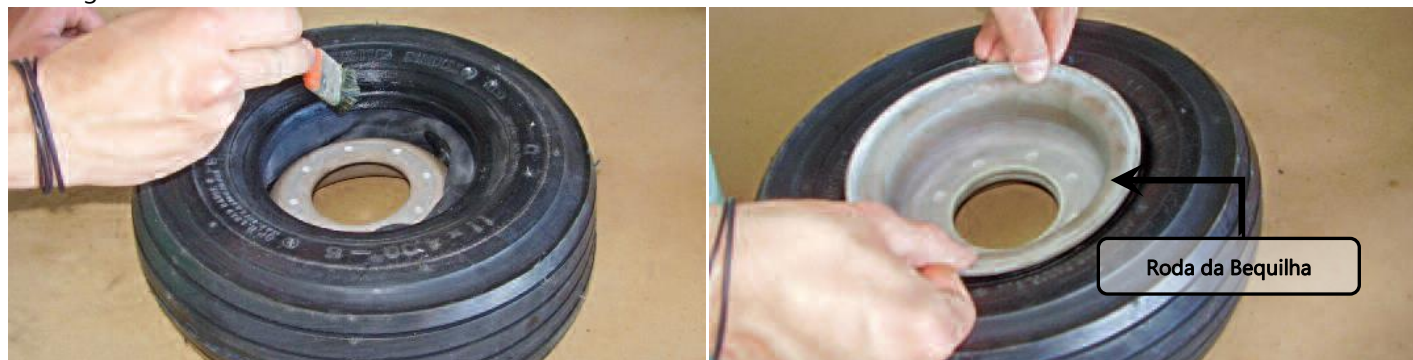
Figura 32.40.40 – Aplicação de graxa e encaixe da meia-roda, lado sem bico.
