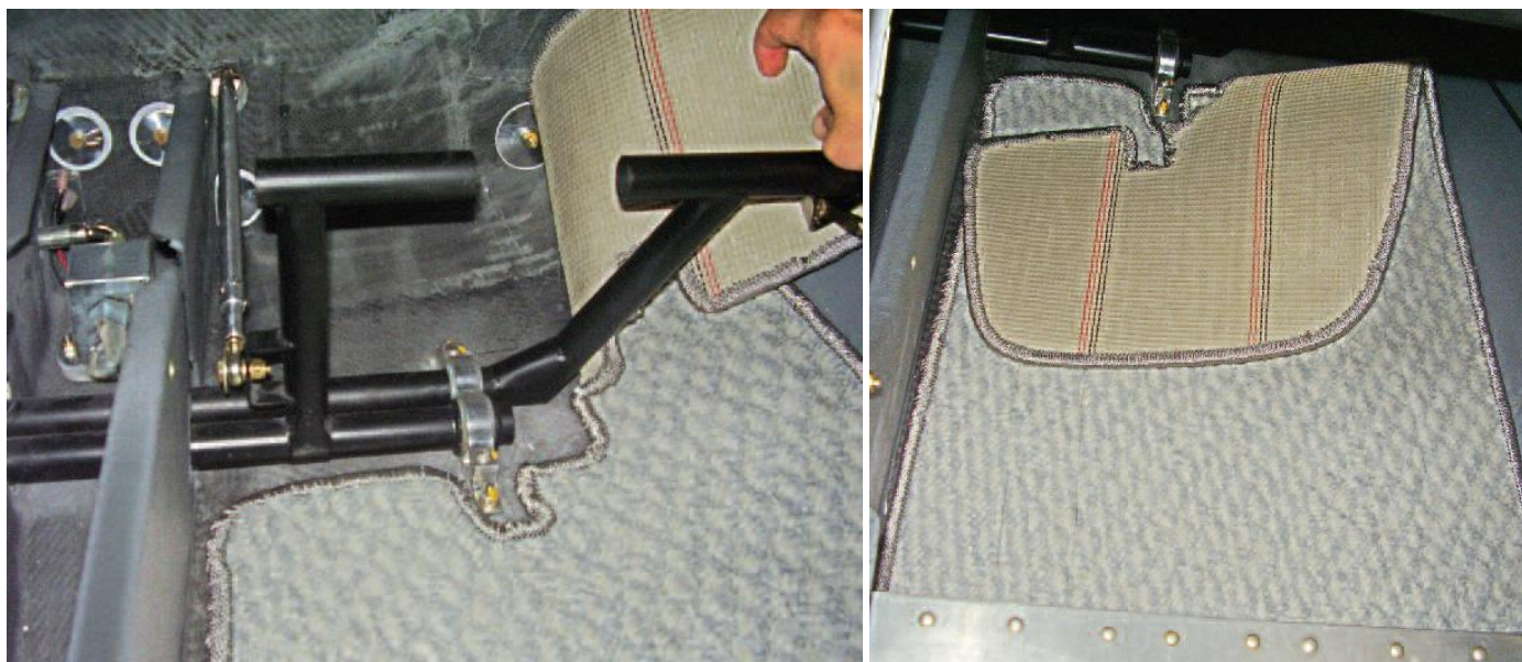
Figura 25.10.19 – Para sua remoção, retirar primeiramente sua parte dianteira trazendo-a para frente do pedal.
