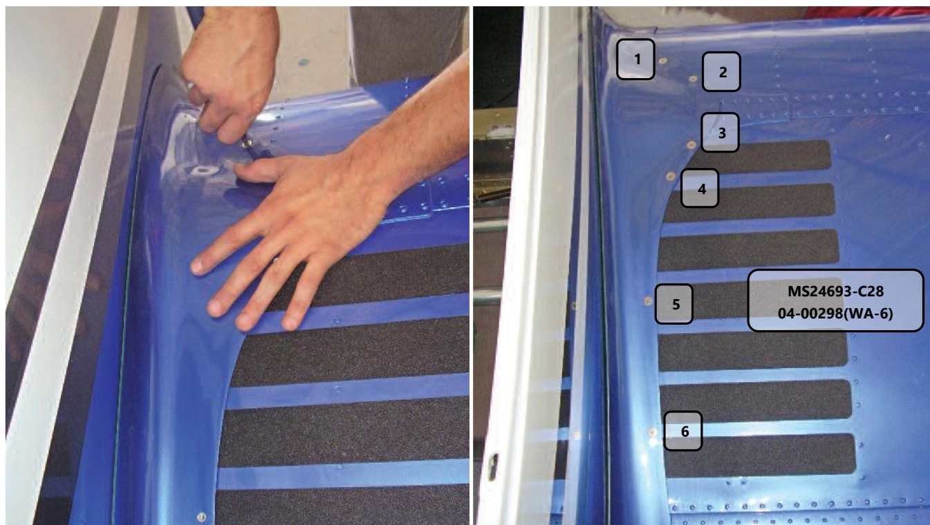
Figura 53.50.5 – Fixação superior da saia da asa.
