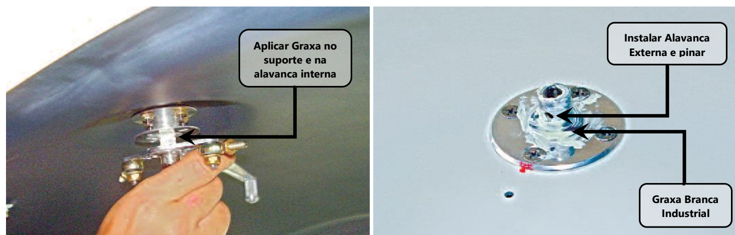
Figura 52.10.22 – Aplicação de graxa na alavanca interna e suporte
