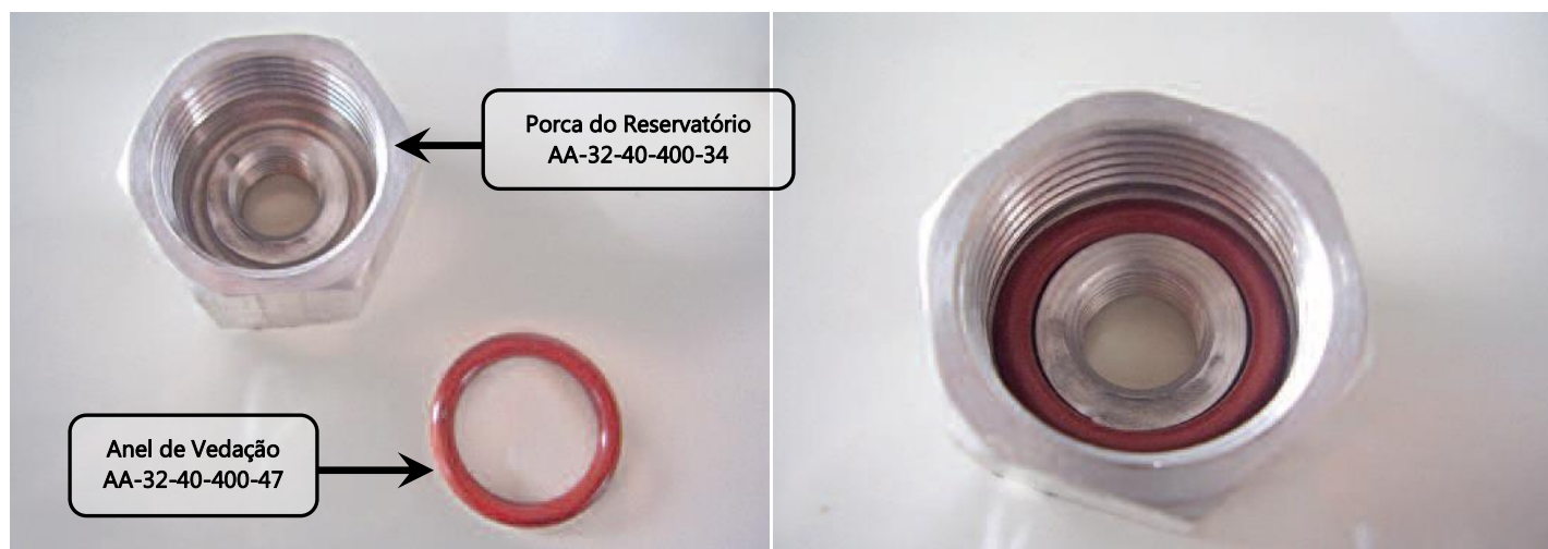
Figura 32.40.79 – Conexão do reservatório (detalhe).
