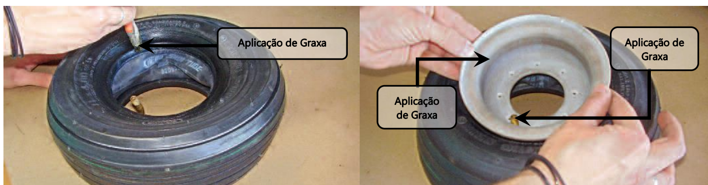
Figura 32.40.39 – Aplicação de graxa e encaixe da meia-roda.
