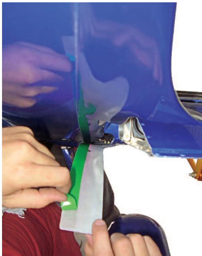
Figura 53.50.9 – Fixação da junção do intradorso da saia.
