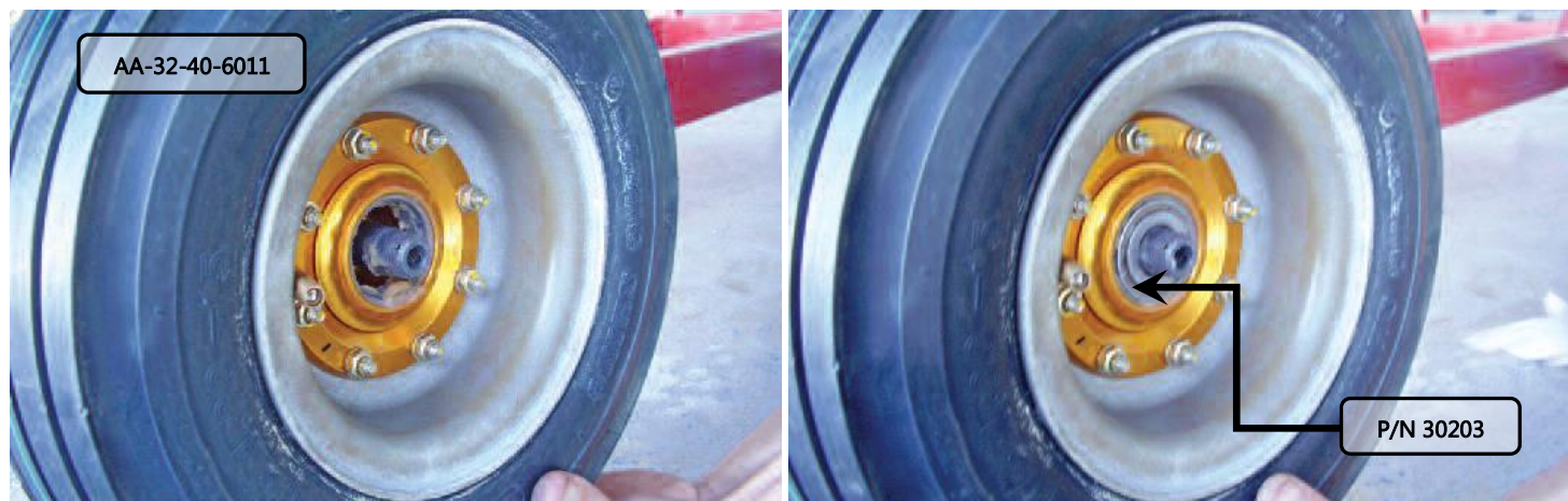
Figura 32.40.25 – Instalação do rolamento externo.
