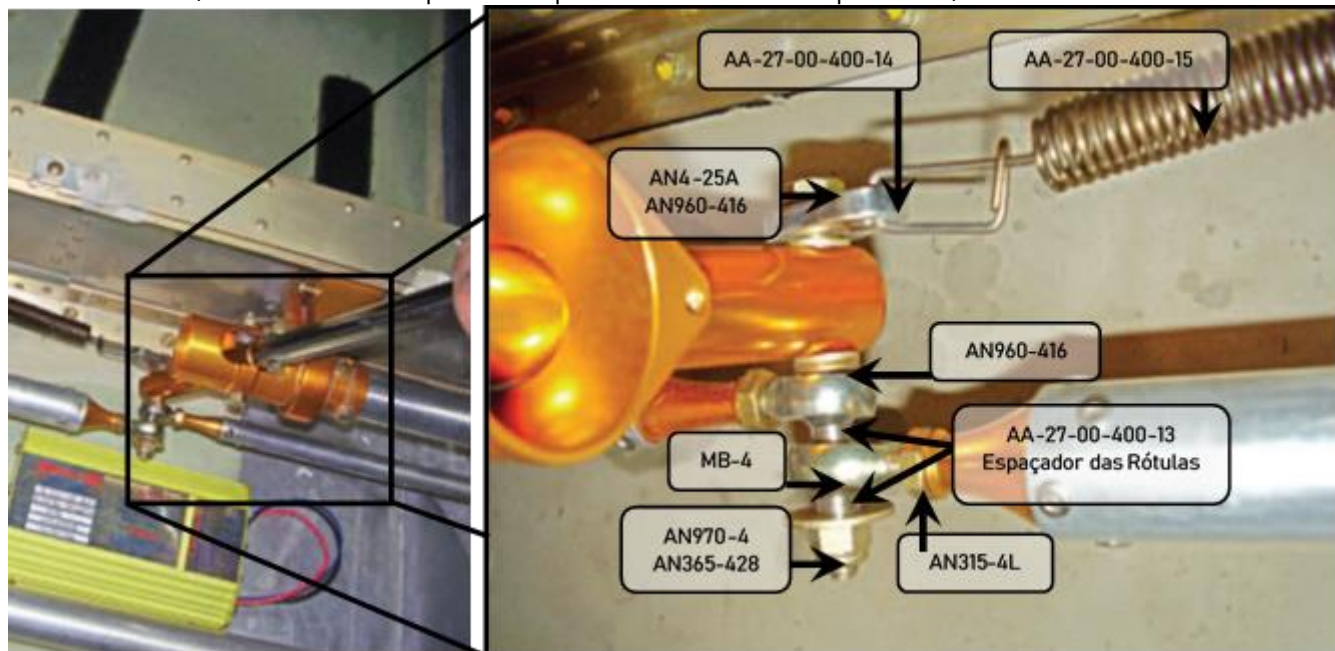
Figura 27.10.12 – Hardwares da instalação do tubo de comando no manche
