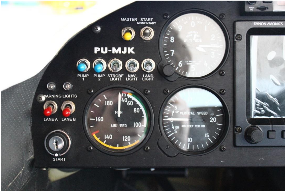
Figura 74.30.3 – Painel esquerdo de um Quasar com motorização 912 iS: partida do motor se dá pelo switch START.
