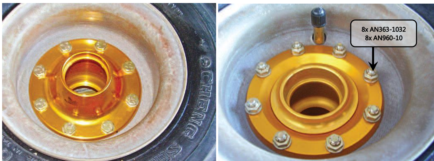
Figura 32.40.43 e 44 – Instalação das duas porcas e parafusos iniciais, e posteriormente todos.
