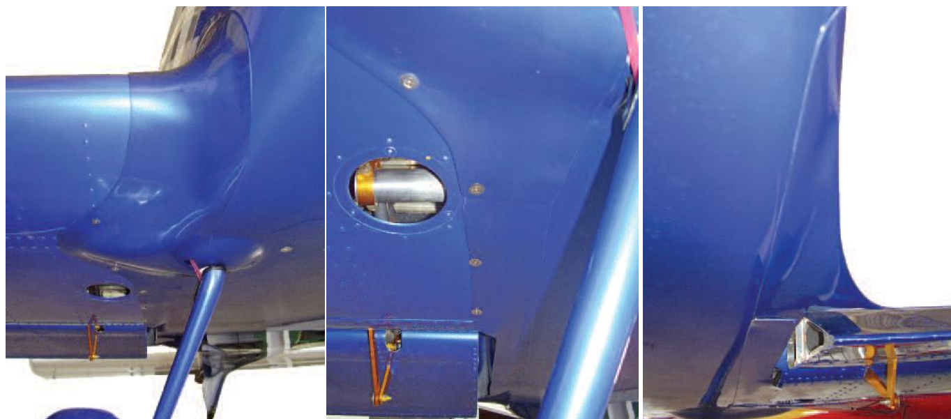
Figura 53.50.11 – Disposição final da saia no intra-dorso da asa (bordo de ataque, seção central, bordo fuga).
