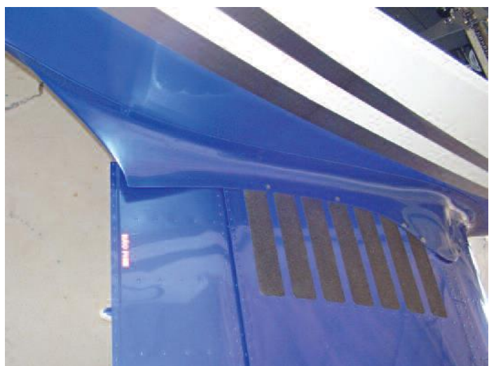
Figura 53.50.10 – Disposição final da saia no extradorso da asa.
