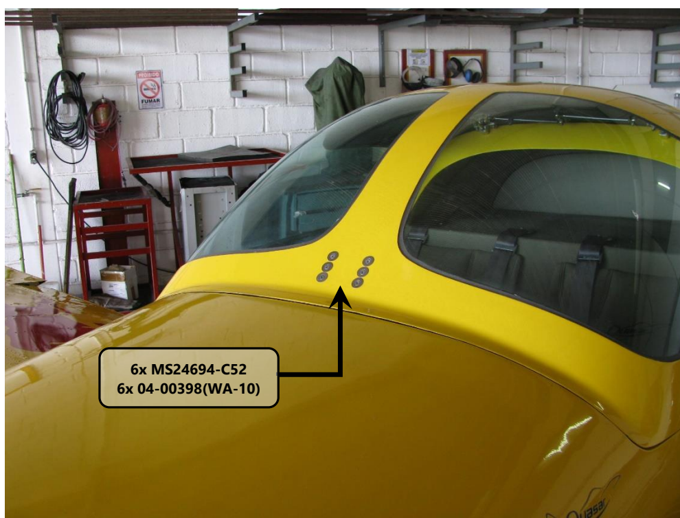
Figura 52.10.29 – Parafusos de fixação do canopy
