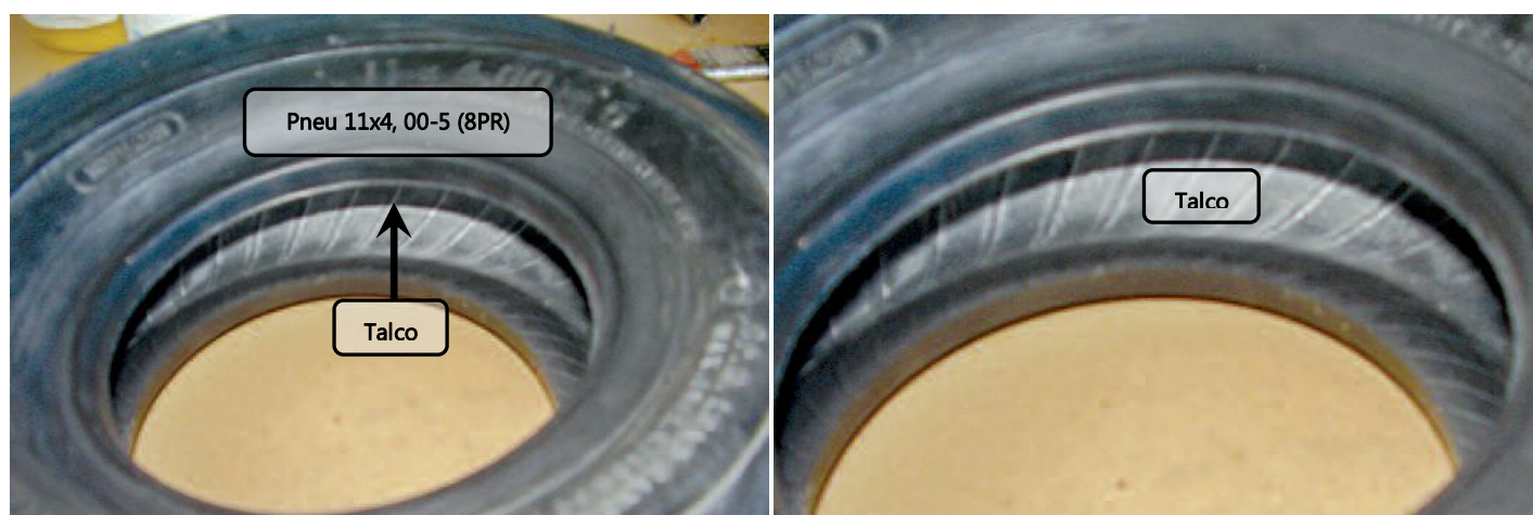
Figura 32.40.35 – Aplicação de talco no interior do pneu.
